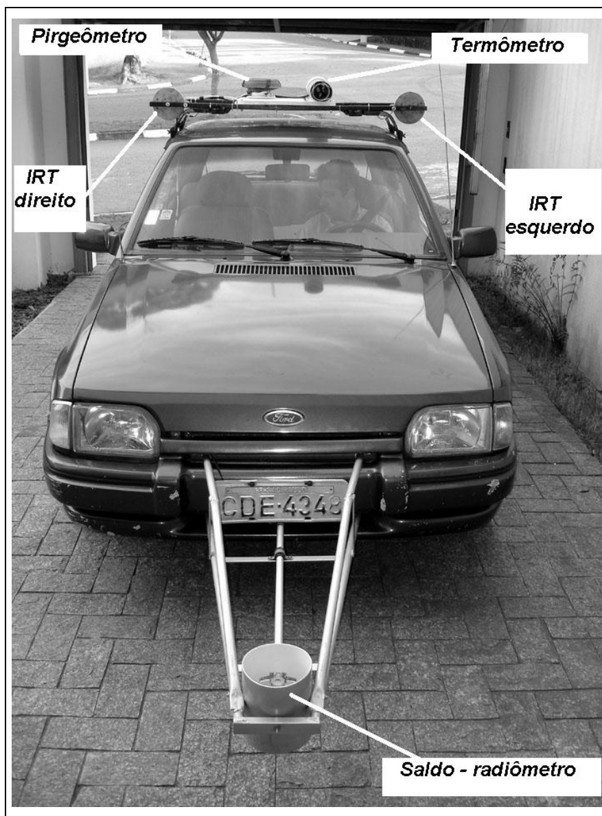
Figura 3: Laboratório móvel em perspectiva frontal. Na proa do veículo dispositivo com saldo-pirradiômetro. Acima, plataforma móvel composta por termômetro inserido em tubo ventilado (centro, à direita), pirgeômetro com proteção (centro, à esquerda) e polias com termômetros infravermelhos de precisão (IRTs) fixos nas extremidades laterais, tanto à direita, como à esquerda do veículo. O sistema de aquisição de dados está posicionado à direita do condutor, no interior do veículo e não pode ser visualizado nesta foto (MACHADO, 2009; 2011). Fonte: acervo fotográfico do Prof. Dr. Tarik.Rezende de Azevedo.
