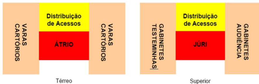
Figura 03 - Esquema do zoneamento funcional interno dos Fóruns da década de 30. Crédito: CORDIDO 2007.
