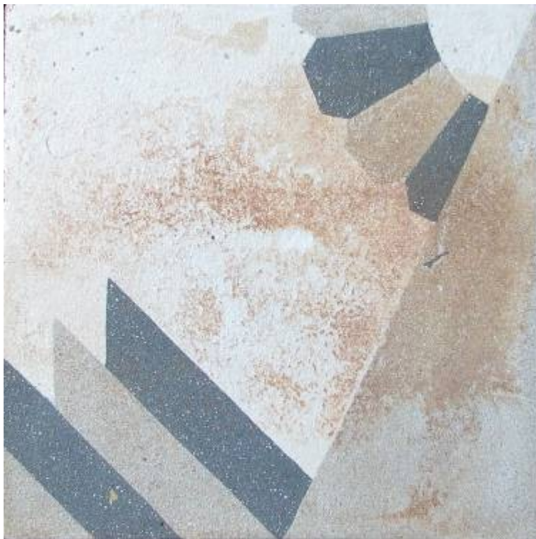
Figura 13: Unidade de ladrilho hidráulico resgatado no quintal da sede da fazenda Forquilha. Ladrilho contínuo, tamanho 20 x 20 x 1,5 cm. Acervo AHE Serra do Facão, Catalão, Goiás.
