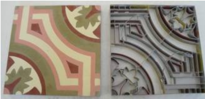
Figura 5: Fôrma moderna de ladrilho hidráulico em metal. Foto cedida pela Marsou Engenharia Ltda, Goiânia (2010). Onde em cada divisória são inseridas as "tintas"/caldas de cimento branco, água e o(s) óxido(s).
