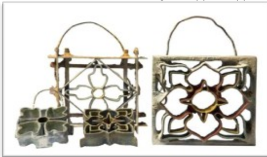
Figura 6: Fôrma de ladrilho hidráulico, aonde uma forma se encaixa sobre a outra. Nas fôrmas são depositadas as porções de tinta que não se misturam umas com as outras, uma camada de cimento seco e outra de argamassa de concreto. Em seguida desenforma, deixando repousar por 12 horas, e depois a imersão em água por 8 horas, e por fim a cura por 20 dias. Fonte: Estadão.com. br.
