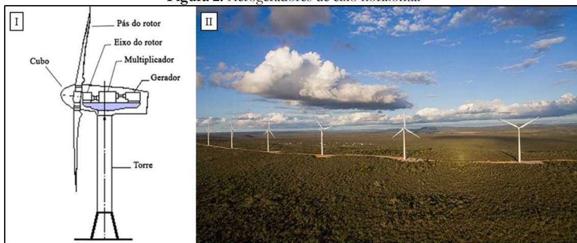
Figura 2. Aerogeradores de eixo horizontal
