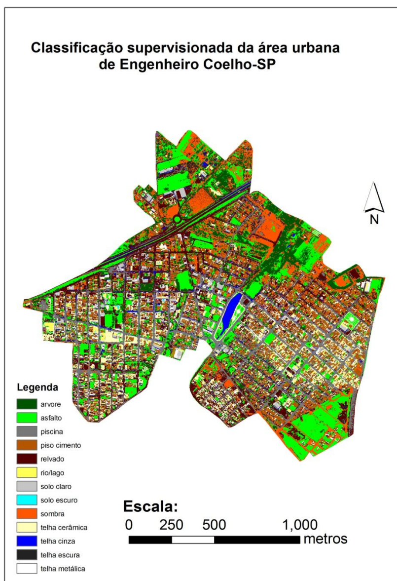
Figura 4: Mapa temático gerado por meio de sensoriamento remoto e sistemas de informação geográfica da classificação supervisionada da área urbana de Engenheiro Coelho-SP.
