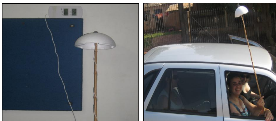
Figura 1. Equipamento de campo utilizado nos transectos: sensores digitais de temperatura Org.: ALEIXO, 2008.
