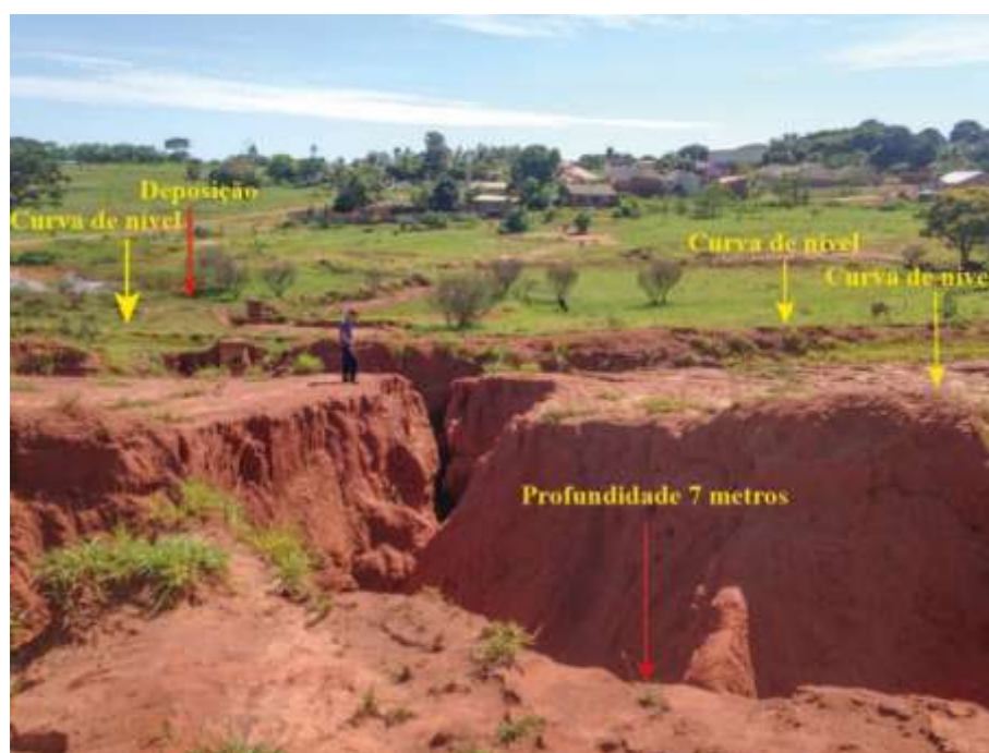
FIGURA 8: Feição erosiva no setor norte da área urbana de Cidade Gaúcha – PR. Fotografia: Autor. Data: (15/01/2015).
