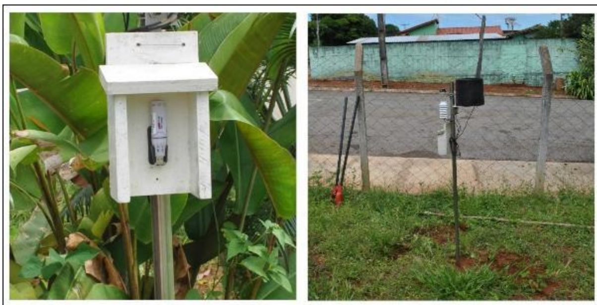
FIGURA 3 - Termohigrômetro e Estação meteorológica. Fonte: Org. do Autor (2014)
