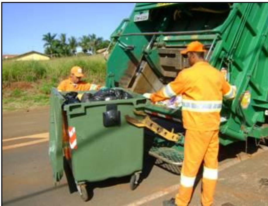
Figura 04 – Procedimento de Coleta através dos contêineres de 1000 litros (Fonte: Imagens disponibilizadas pela empresa CORPUS Saneamento e Obras Ltda., 2013.)
