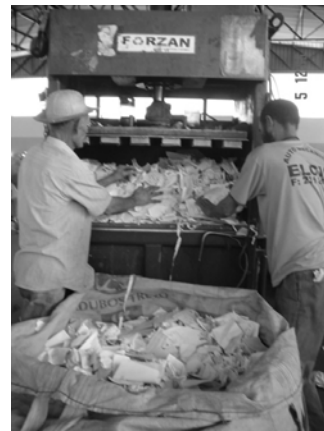
Fotos 05 e 06: Cooperados triando os materiais recicláveis e depois os colocando na prensa para serem enfardados. Fonte: Trabalho de campo 2007.
