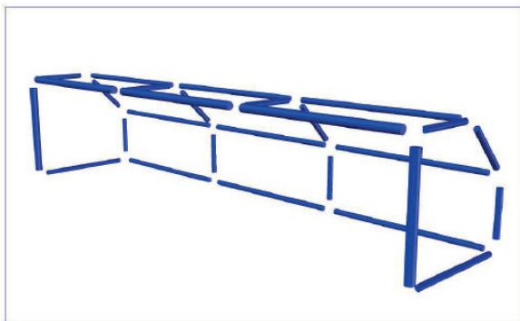
Figura 2. Segmentos modulares da baliza. Fonte: elaboração própria.
