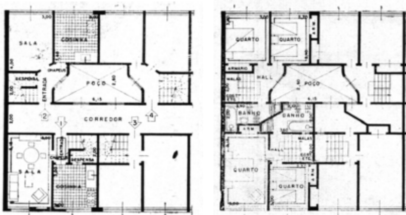
Figura 4: Plantas do apartamento duplex do Conjunto Japurá. Fonte: Revista Arquitetura e Engenharia, abril –junho de 1955, nº 35
