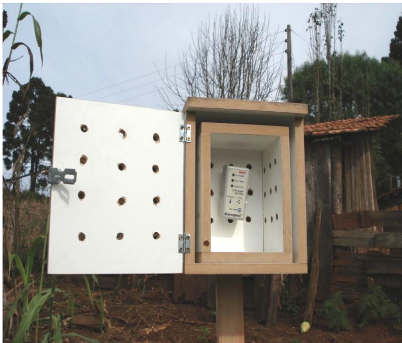
Figura 02 - Miniabrigo meteorológico com data logger para coleta de dados
